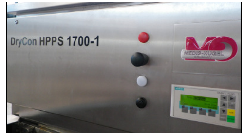
„DryCon HPPS 1700-1“ mit Siemens Steuerung
