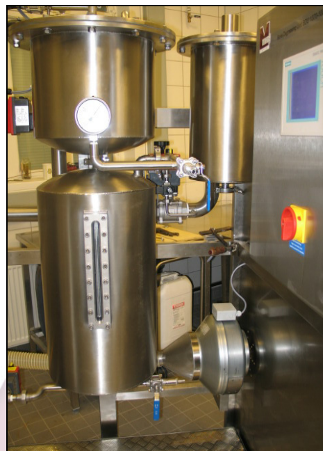
Dichlormethan-Rückgewinnungsanlage mit Kondensator und Vorratsbehälter.
